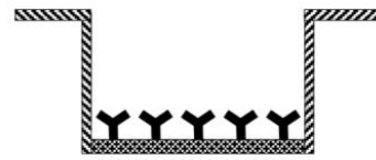
图1. 预包被IgG1抗体微孔板 孔板上预包被了抗小鼠IgG1特异性抗体。
